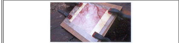
Solariser la plaque au soleil (ou sur un appareil de solarisation UV) dans un cadre de contact
