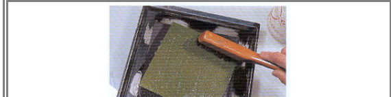
Brosser la plaque. Remarquez que l'eau a enlevé le polymère seulement dans les zones non exposées
