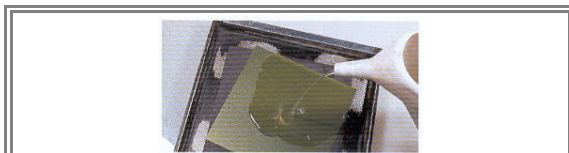
Verser l'eau (+ un peu de soude) sur la plaque
